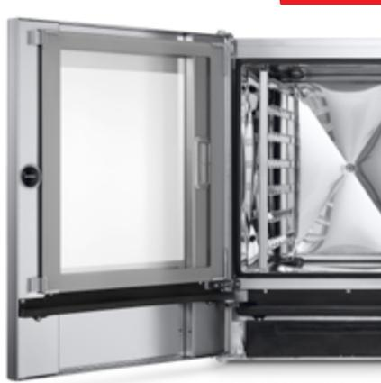
Puerta de cierre con doble cristal templado, exterior con efecto vidriado, a intersticio de aire y cristal interior con reflector para reducir la irradiación de calor hacia el operario y obtener mayor eficiencia.
