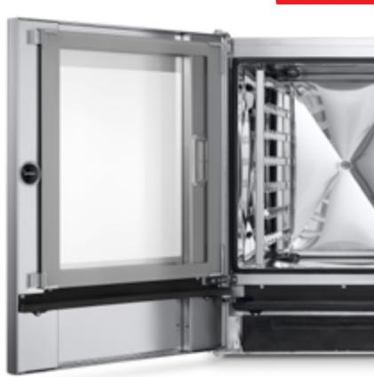
Puerta de cierre con doble cristal templado, a intersticio de aire y cristal interno termorefllector para reducir la irradiación de calor hacia el operario y obtener mayor eficiencia.
